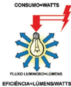
Exemplo: uma lâmpada incandescente proporciona, em média, uma eficiência luminosa de 17 lm/W (o que dá para iluminar uma sala de aula de 30 m<sup>2</sup>, com 4 a 8 lâmpadas de 100 Watts) e uma lâmpada fluorescente compacta proporciona 65 lm/W. Assim, a lâmpada fluorescente tem uma eficiência luminosa cerca de quatro vezes maior que a de uma lâmpada incandescente.
