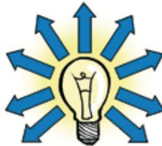
É definida como a concentração de luz em uma direção específica, radiada por segundo. Ela é representada pelo símbolo  $I$  e a unidade de medida é a candela (cd). Pode ser comparada com a intensidade de um jato de água em determinada direção.
