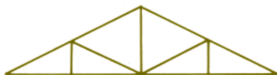
tesoura de telhado
