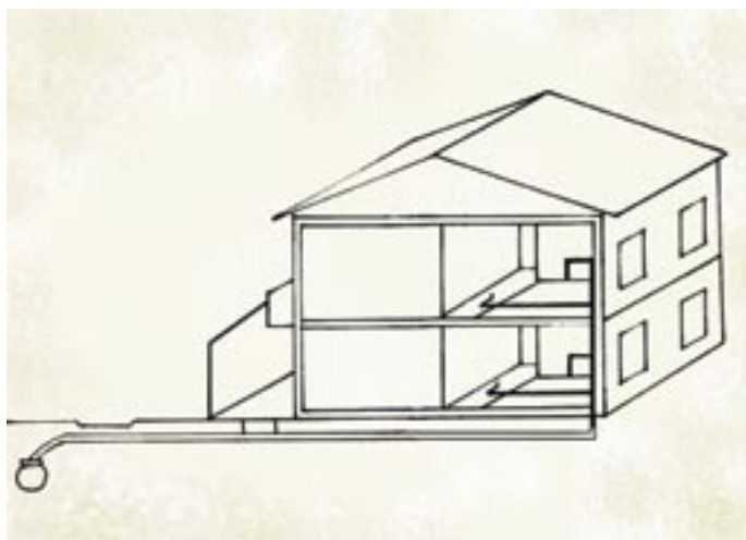
Sistema direto de distribuição de água.
