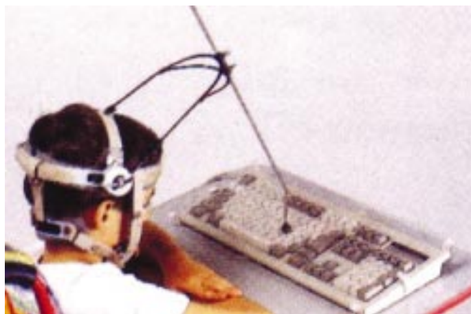
Foto 6 - Haste fixada na cabeça para digitação
